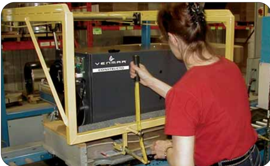
Au poste de montage d'échangeur d'air, Roxane Paquette utilise désormais un système mécanique de fermeture des attaches, prévenant ainsi les mouvements à risque, telles que extension et flexion du cou, du dos, de l'épaule et du poignet.
