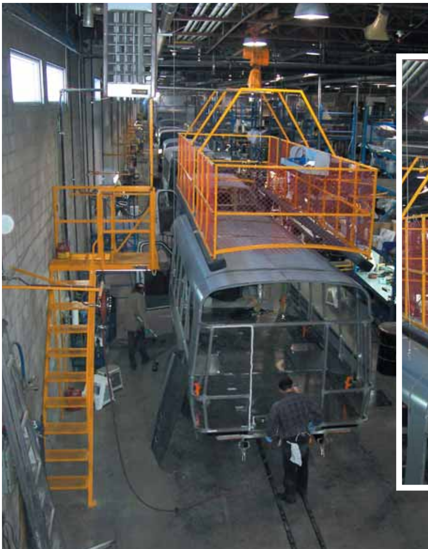
Un garde-corps amovible, actionné par un treuil et accessible par une passerelle coulissante ajustable, vient ceinturer le dessus des véhicules en fabrication.
