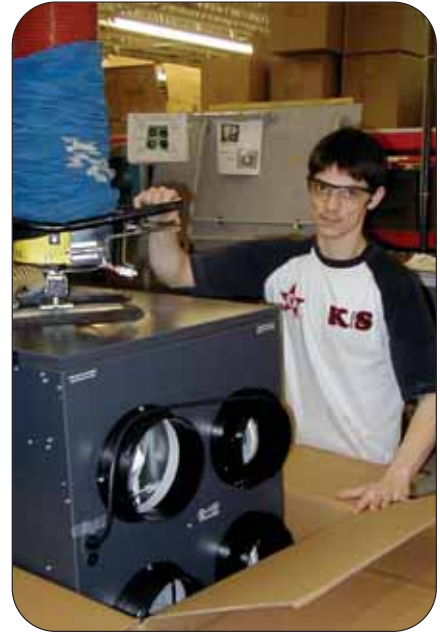
Au poste d'emballage, un nouveau système de ventouses pneumatiques permet à Sébastien Lavallée de soulever sans effort le produit à emballer.
