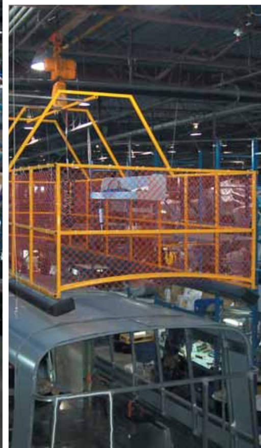
Un garde-corps amovible, actionné par un treuil et accessible par une passerelle coulissante ajustable, vient ceinturer le dessus des véhicules en fabrication.
