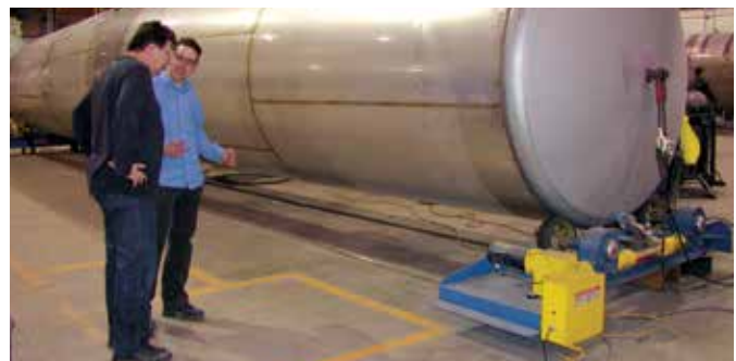
Marc-Antoine Kenline (à droite) explique à Claude Millette, conseiller en prévention de l'ASFETM, le fonctionnement des barres d'espacement et de retenue qui permettent de maintenir en place les deux parties mécaniques du positionneur de la citerne en cours de fabrication.
