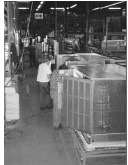
Quelques travailleurs de BLANCHARD-NESS s'affairent à l'assemblage de groupes compresseur-condenseurs.
