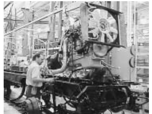
Poste de travail qui a fait l'objet d'une étude ergonomique : « pose du moteur »
