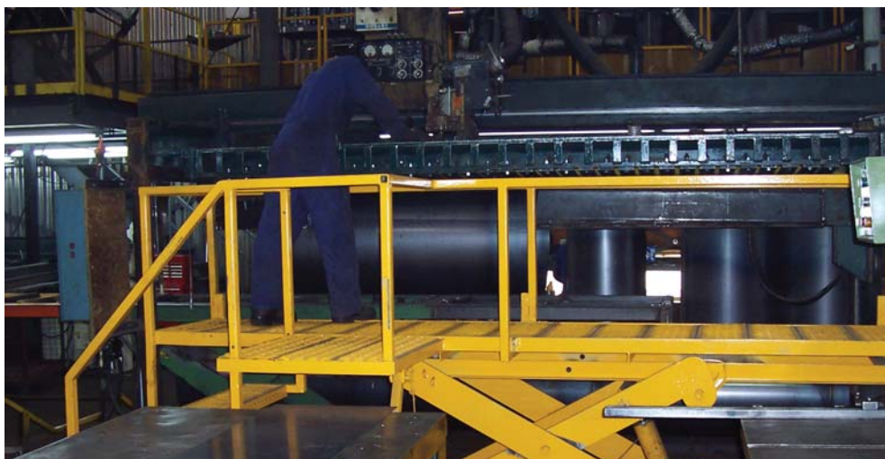
Une plate-forme hydraulique à ciseaux ajustable permet une posture confortable et un travail efficace.
