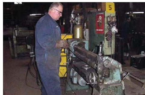
Sur ce rouleau tordeur à métal, un système mécanique pour réduire la vitesse permet de prévenir les blessures aux mains.
