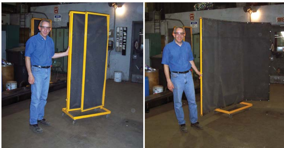
Serge Maheux , directeur d'usine chez Rodrigue Métal, pose devant un écran protecteur mobile et pliable, particulièrement utile et fonctionnel.
