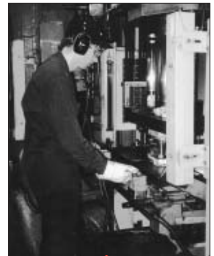
L'opérateur Eric-Pierre Martel s'apprête à insérer la pièce dans une deuxième presse qui sert à la découper.
