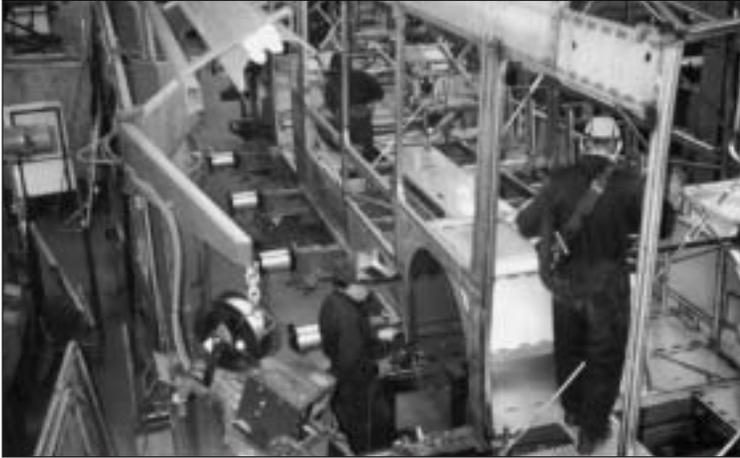
Chez Nova FABTECH, Division Prévost Car Inc., on fabrique des structures d'autobus à plancher bas.
