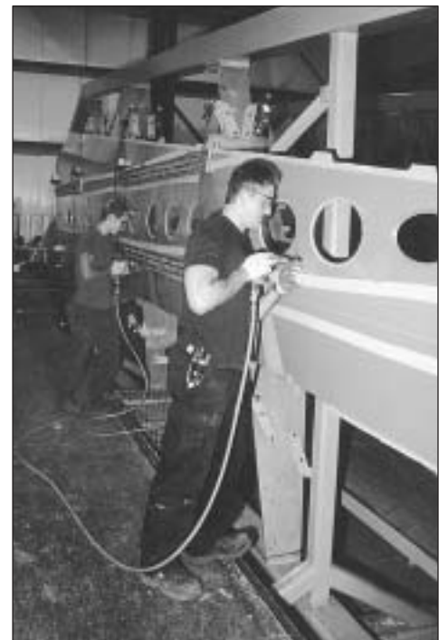
Installation des rivets à l'étape finale d'assemblage de la voilure.
