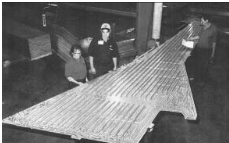
Vérification de la condition générale de la voilure, suite au machinage.
