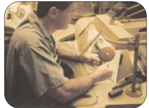
Auparavant, le travailleur devait tenir la pale devant la meule, en effectuant de constants mouvements de va-et-vient avec les deux bras.
