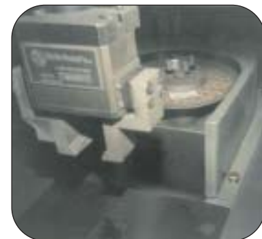
Désormais, un bras robotisé saisit la pièce et la mène devant la meuleuse.
