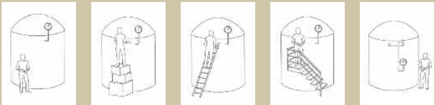
Exemples de stratégies de prévention des chutes de hauteur illustrant le principe « éliminer, limiter, empêcher » Source : IRSST
